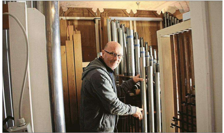
DIE PFEIFEN DER ORGEL, die aus Wolfsburg kommt, sind hintereinander aufgebaut worden, erklärt Orgelbaumeister Hans-Martin Luge. Die alte Orgel der Bernharduskirche konnte man wegen des Schimmelbefalls nicht mehr sanieren. Foto: Holbein
